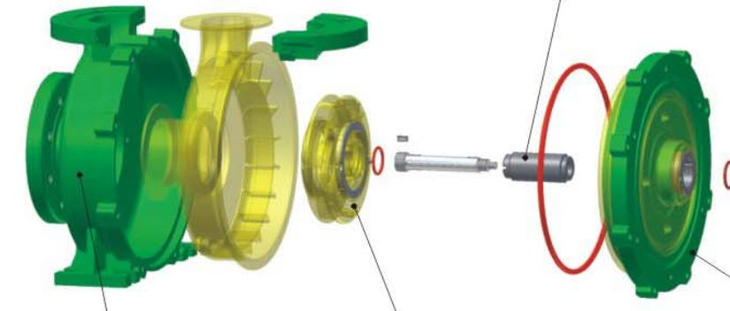
球狀石墨鑄鐵前蓋護體內襯碳纖維強化ETFE氟素塑脂，兼顧結構強度及泛用化學藥液的抵抗。護體外層塗佈環氧樹脂底漆及PU樹酯面漆，兼俱耐蝕及耐候性。
