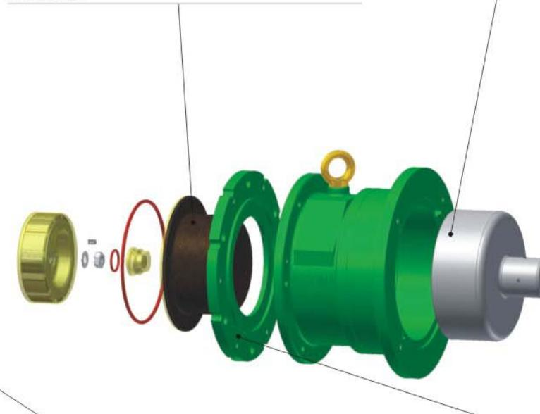
高強度支撑軸承結構體：加大軸承框軸承支撐面積，配合高扭矩安全及高純度SiC軸向及徑向軸承的採用，超耐磨耗及腐蝕。
