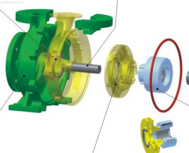
由泵浦流力設計軟體計算出最佳流道幾何，將流力損失降至最低，提高葉輪流力效率。
